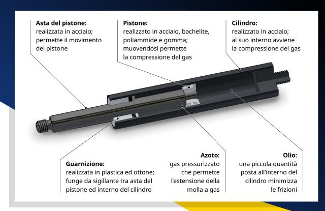
La Molla a Gas funziona attraverso la compressione dell'azoto pressurizzato all'interno del cilindro. Questo accade quando l'asta del pistone viene spinta dal peso del portellone o cofano all'interno del cilindro spingendo il pistone stesso e comprimendo il gas, garantendo la cosiddetta "forza di estensione" quando il portellone verrà riaperto.
